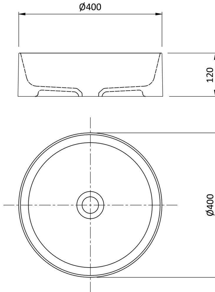
Perçages diamètre 35 mm pour les vidages automatiques, mitigeurs et distributeurs de savon.
