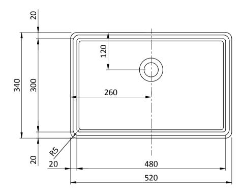
Perçages diamètre 35 mm pour les vidages automatiques, mitigeurs et distributeurs de savon. Gabarits et informations techniques : PDF et DXF téléchargeables sur www.kibell.fr/service
